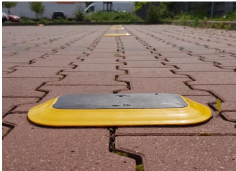
Bildunterschrift: Der Belegungszustand der Parkflächen wird durch Sensoren erfasst. (Quelle: Smart City System).
