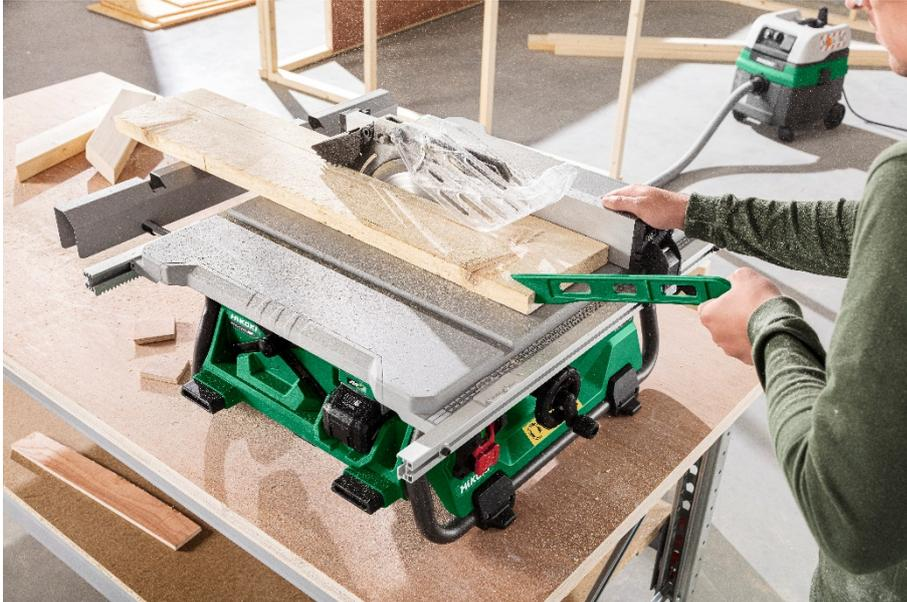
**03** – Dank ihres hocheffizienten bürstenlosen Gleichstrommotors und leistungsstarker Multi-Volt-Akkus erreicht die C3610DRJ(X) die gleiche Schnittleistung wie vergleichbare kabelgebundene Tischkreissägen. (Quelle: HiKOKI)
